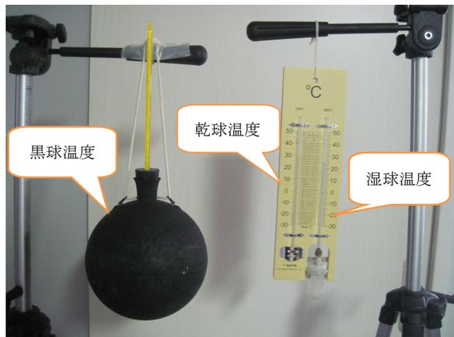
測定に使用する温度計です。写真の左が黒球(6インチ)温度計です。輻射熱を測ります。写真の右はアウグスト温度計です。乾球温度および湿球温度は自然気流に暴露された温度計を用いることになっているため、この温度計で測ります。測定位置は地上1.2～1.5mに置きます。暑さ指数は、3つの測定値から計算して求められます。
