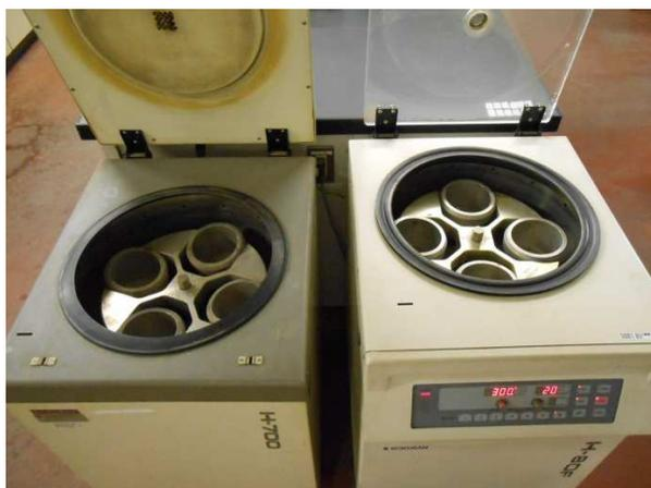
これらの装置は、土壌及び廃棄物等の分析で溶出液を作成するために使います。写真上の装置は、試料と溶媒を入れた容器をセットして、振とうすることができます。写真下の装置は、振とう後の溶出液を遠心分離し、上澄み液と試料とに分けることができます。
