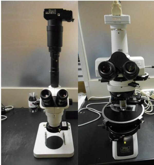
当社では、ISO(国際標準化機構)等で石綿分析に採用されている偏光顕微鏡及び実体顕微鏡を3月に導入いたしました。
