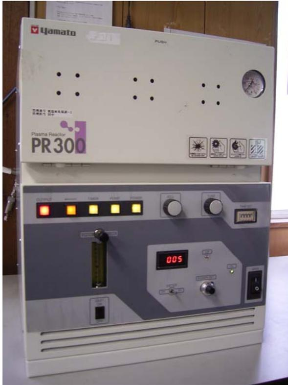
この装置は、JIS K 3850-1(空気中の繊維状粒子測定方法－第1部:光学顕微鏡法及び走査電子顕微鏡法)に記載されている装置で、酸素をプラズマ化することにより、有機物と酸素を反応・結合・ガス化させて除去することができます。
