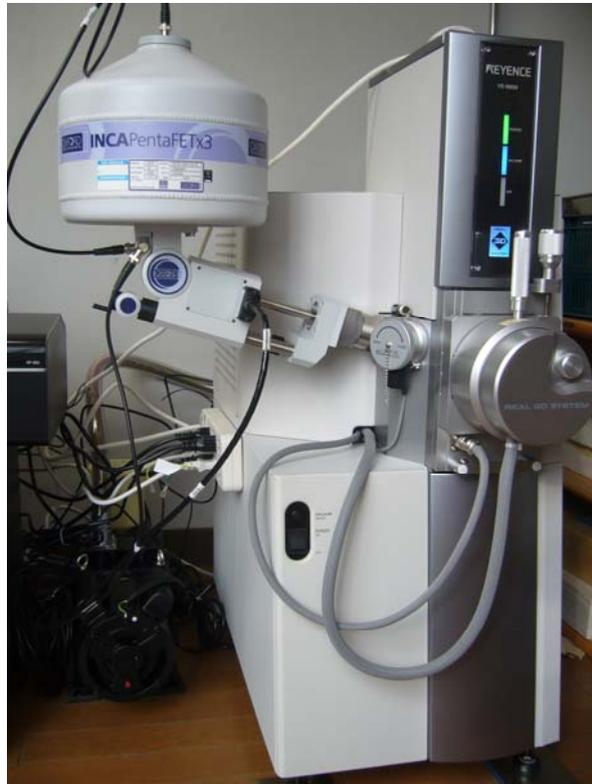
この装置は、微細試料の表面観察及び異物等の定性・定量分析に使用しています。以前、センター設備紹介でご紹介致しましたSEM-EDX(走査型電子顕微鏡・エネルギー分散型蛍光X線分析装置)よりもコンパクトサイズとなっています。
