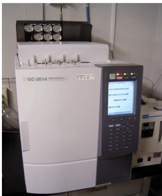
この装置は、燐及び窒素化合物等の分析に使用しています。この GC はセンター設備紹介 (Vol.13) でご紹介致しましたGC-2014 にFTD検出器(熱イオン化検出器)が付いています。加熱された雰囲気中にアルカリ金属塩を入れると、アルカリ金属の蒸気がイオン化されます。そこに燐や窒素の化合物が入るとアルカリ金属の熱イオンが増加します。FTD検出器は、その増加を検知する仕組みになっています。
