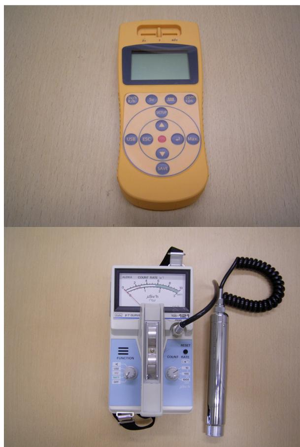
写真上の装置は、 $\alpha$ 線、 $\beta$ 線、X線、 $\gamma$ 線の4種類の放射線を測定することができます。サイズは奥行170mm×幅74mm×高さ30mmとコンパクトで、単4電池3本で動きます。放射線量率は、 $0.01 \mu\text{Sv/h} \sim 1000 \mu\text{Sv/h}$ まで、放射線量累計値は、 $0.001 \mu\text{Sv} \sim 999999\text{Sv}$ まで測定可能です。
